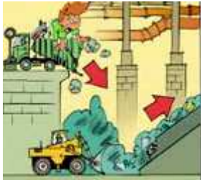
Quai déchargement et fosse
